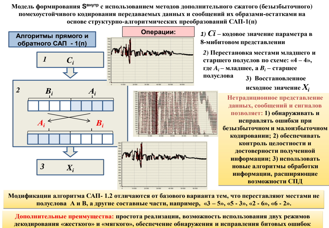
Рисунок 1 – Основные операции предлагаемого алгоритма дополнительного помехоустойчивого кодирования с использованием структурно-алгоритмических преобразований (САП-1(п)) и графические результаты достигаемого при этом комплексного положительного результата
