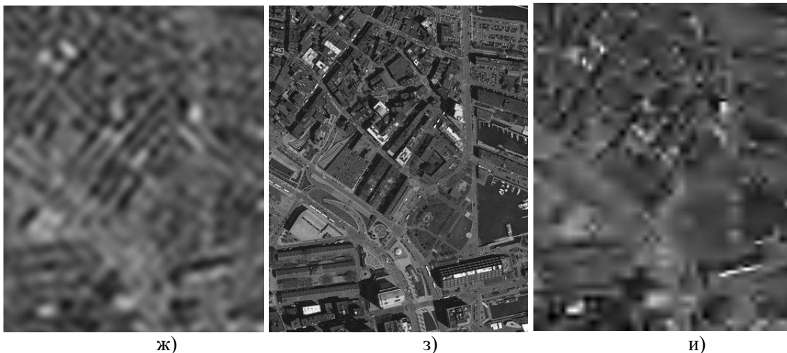
Рисунок 4 – Сравнение результатов сжатия ИЗП а, г, ж) Субполосный метод K_c=500 ; б, д, з) Исходное изображение; в, е, и) JPEG2000 K_c=500
