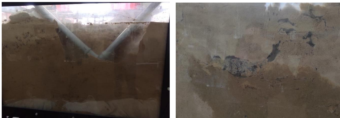
Рисунок 1 – Процесс размыва грунта в лабораторных исследованиях
