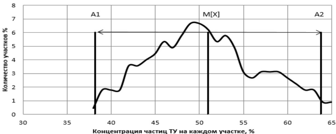
**Рисунок 2– Гистограмма распределение концентраций ТУ в различных микрообъемах вулканизата с ТУ N330, 58 м.ч. на 100 м.ч. увеличение 5000**
