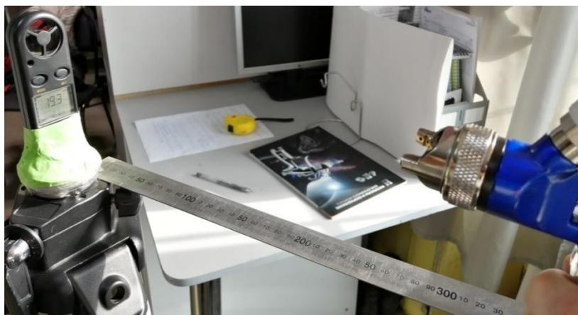
*Рисунок 2 - Измерение скорости воздушного потока*
