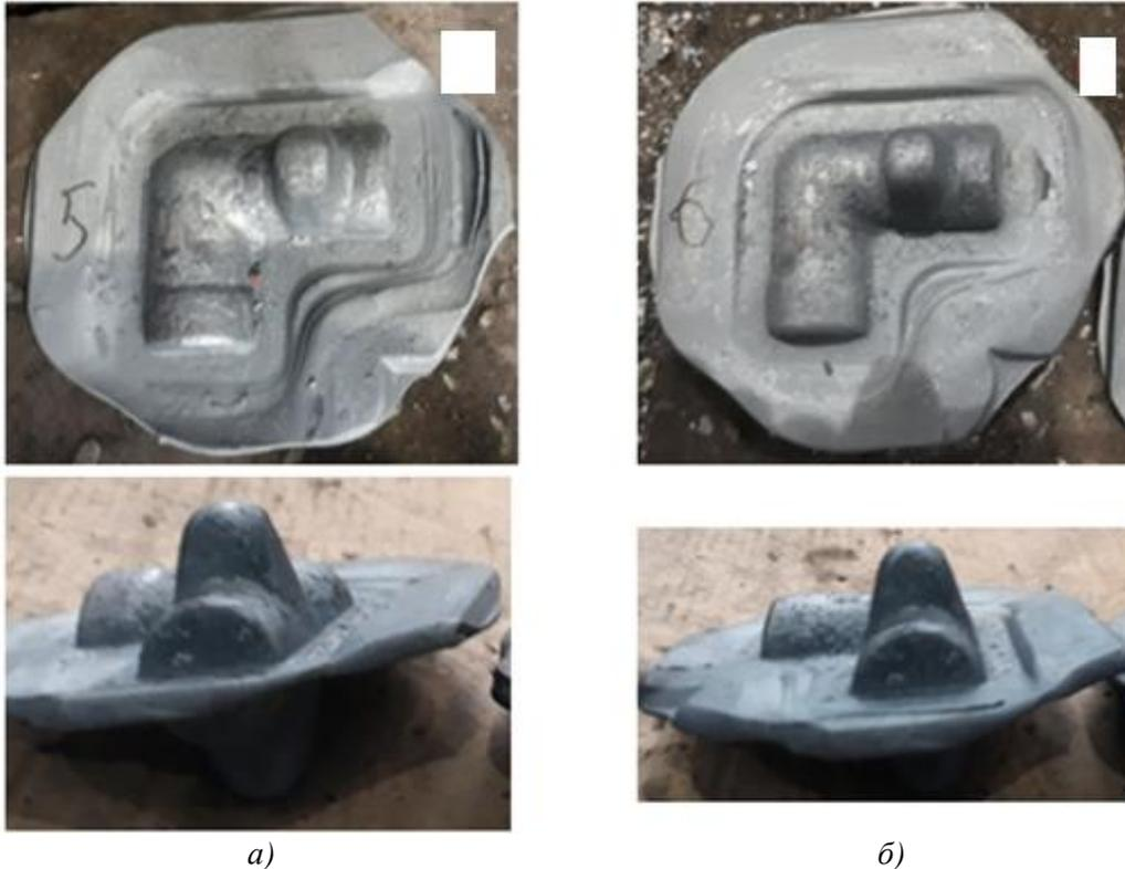
**Рисунок 1 - Фотографии поковки «Угольник», полученной при использовании стандартной бабы молота (а) и бабы молота с наполнителем (б)**
