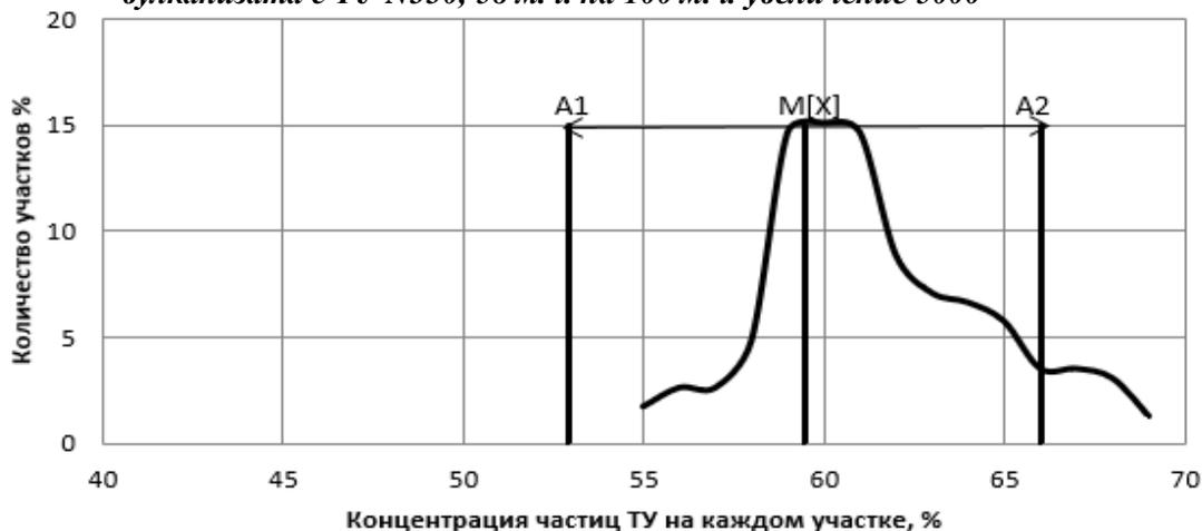
**Рисунок 3– Гистограмма распределение концентраций ТУ в различных микрообъемах вулканизата с ТУ N220, 75 м.ч. на 100 м.ч. увеличение 10000**
