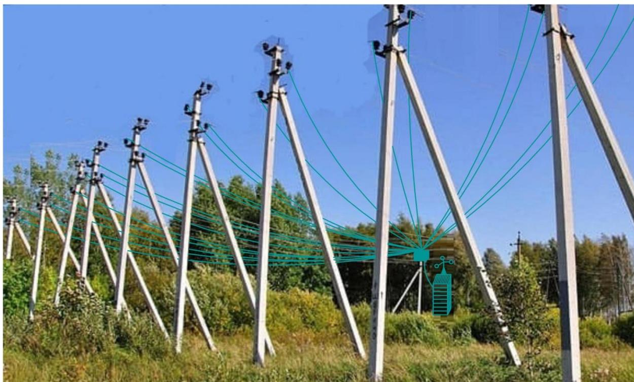
**Рисунок 2 - Внешний вид стационарного измерительного поста для мониторинга действия ветровых нагрузок на провода ВЛ 10 кВ**
