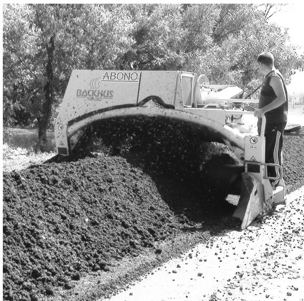
Рис. 7. Ворошитель СВБ16.30 для перебуртовки компостной смеси
