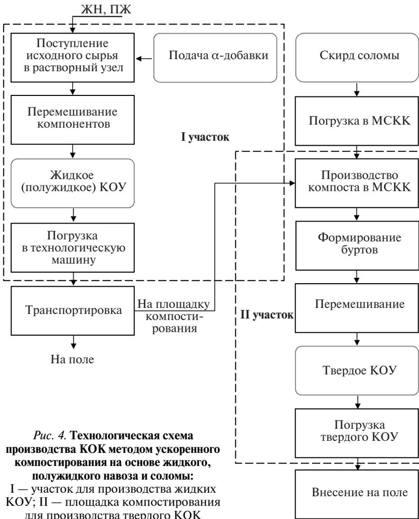
**Рис. 4. Технологическая схема производства КОК методом ускоренного компостирования на основе жидкого, полужидкого навоза и соломы:**
