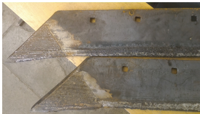
Рис. 3. Лемехи плуга с приваренной лентой У12А Fig. 3. Plowshares of a plow with a welded strip U12A
